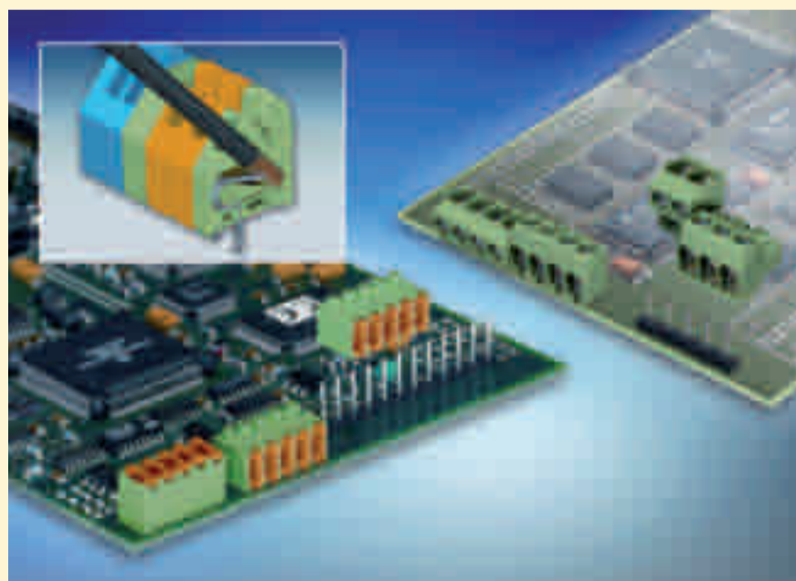
Figura 1 - La nuova serie di morsettiere Combicon Compact
